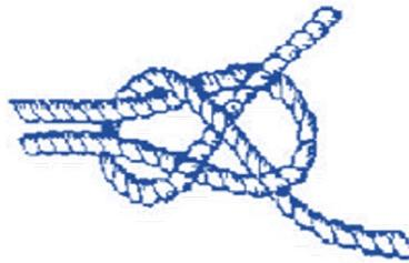
Aplicación del nudo Ajuste: Se utiliza para unir dos cuerdas de diferente grosor.
